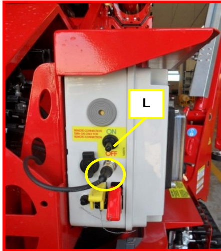
Afbeelding 89: kastje start/stop op het onderstel.
