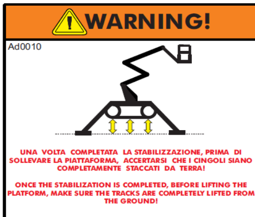
Afbeelding 64: waarschuwing voor stijging rupsbanden.
