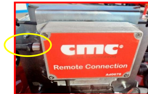
Afbeelding 88: kastje voor verbinding op afstand.
