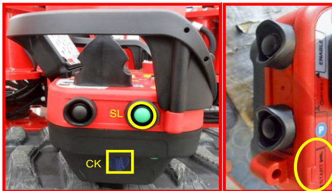
Afbeelding 8a: contactsleutel en knop koppeling afstandsbediening.
