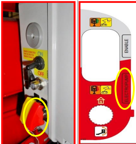
Afbeelding 29: knoppen elektrische pomp.
